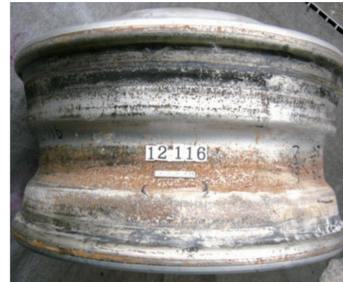
■リム腐食事例写真
