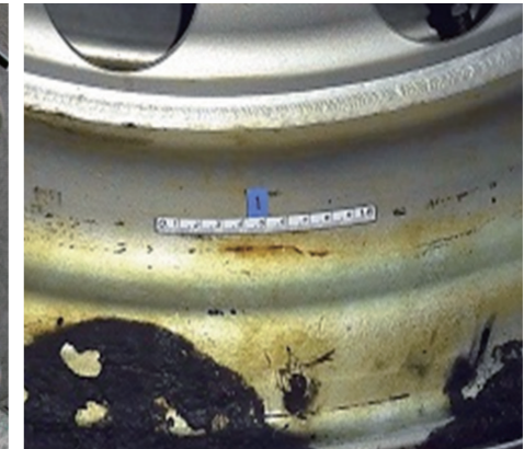
■亀裂部貫通写真
