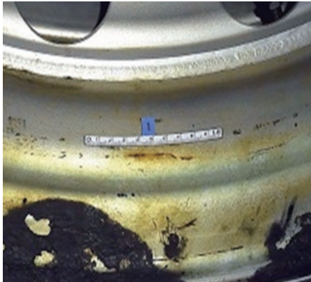
■亀裂部貫通写真
