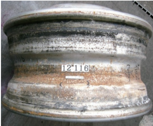
■リム腐食事例写真
