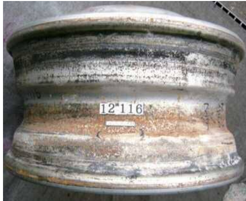
■リム腐食事例写真
