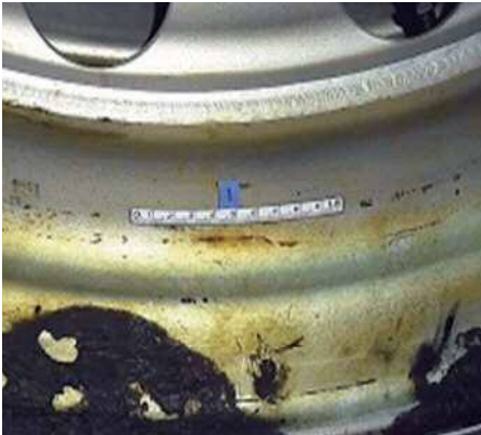
■亀裂部貫通写真
