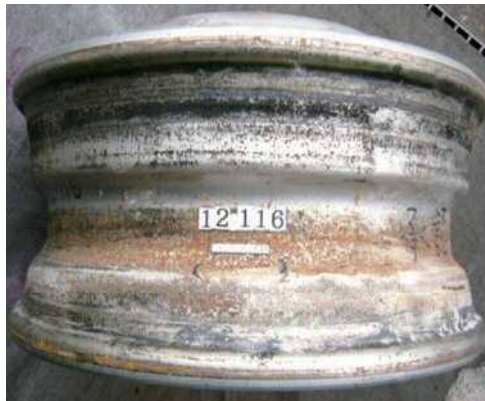
■リム腐食事例写真
