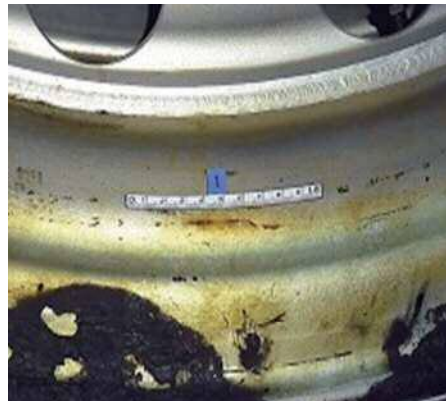
■亀裂部貫通写真
