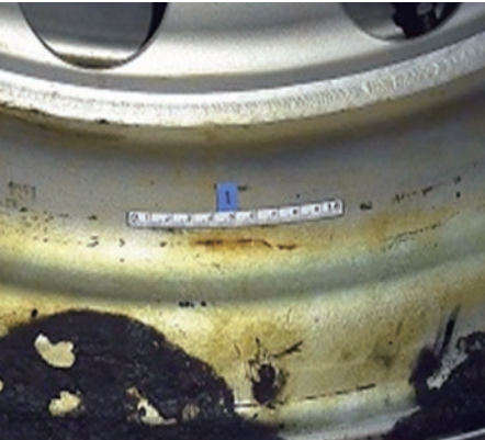
■亀裂部貫通写真
