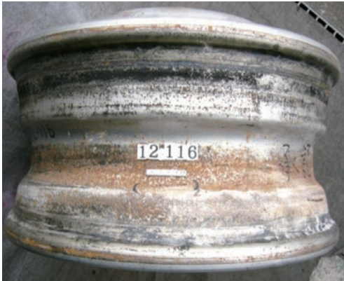
■リム腐食事例写真
